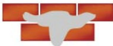
Puede afectar el mortero (el mortero es una mezcla de cemento, arena y agua para la construcción que sirve de pegamento aplicado en las juntas para mantener las piezas de ladrillos unidos).
