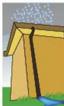
Los canales de desagüe deben mantenerse limpios de desechos para que puedan funcionar correctamente, para esto deben ser examinados regularmente, y así evitar posibles fugas de agua. Los ganchos de los canales o bajantes y en general todas sus partes deben estar intactas, sin óxido, agujeros o partes dañadas. Deben también estar perfectamente alineados y conectados con los de pisos inferiores, con la inclinación necesaria para que el agua fluya.
