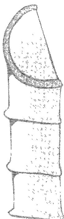
3. Una las dos mitades utilizando alambre dulce o quemado. Para esto puede hacer unos huecos en cada borde de las láminas o colocar dos listones de madera para después sujetarlos con el alambre.
