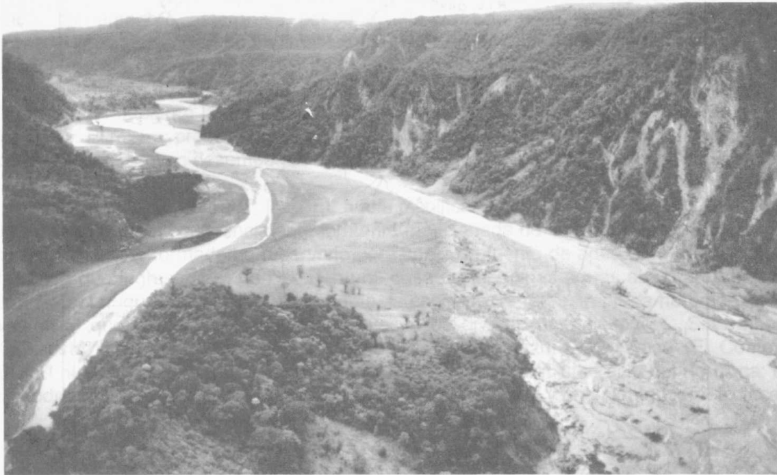
FIGURA 5.21 Vista aguas debajo de la confluencia del río Malo (fluyendo desde la parte izquierda inferior) con el río Coca. Un flujo de escombros procedente del río Malo durante la noche del 5 de Marzo de 1987, formó una presa de corta duración en el río Coca, resultando en la deposición de una gran cantidad de sedimentos en el canal del Coca como se ve hacia la derecha en la parte frontal de la foto.
