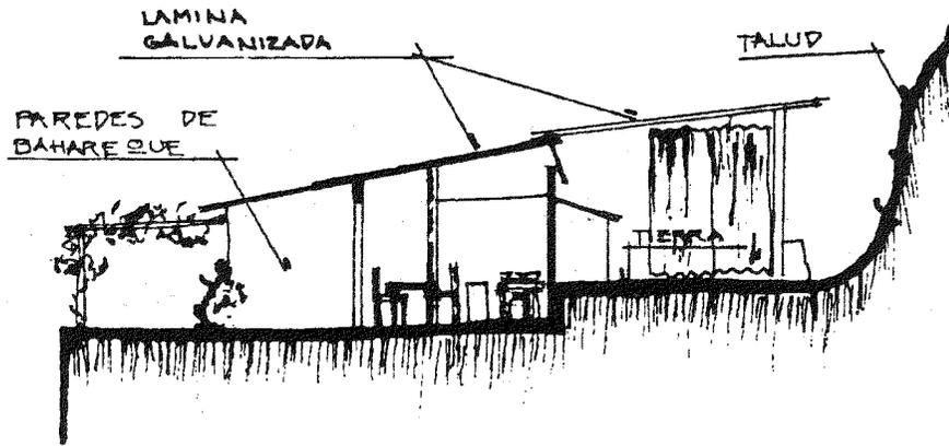
ESQUEMA DE SECCION sin escala
