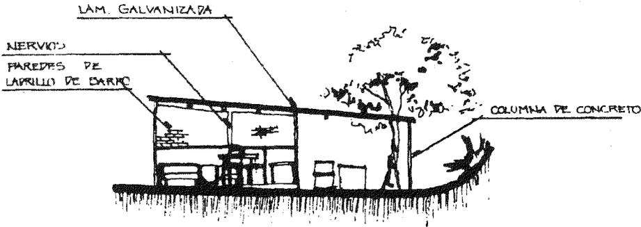
ESQUEMA DE SECCION
