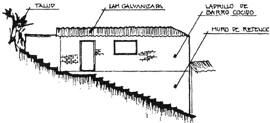
ESQUEMA DE SECCION sin escala
