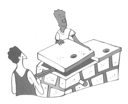
5. Colocación de las losas superiores. En la parte de atrás doben instalarse dos codos PVC de 4" que funcionarán como niecanismo de ventilación de las cámaras.
