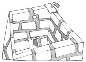
Al terminar de construir las cámaras, éstas se repellan o pañetan en su interior con una mezcla de cemento y arena.
