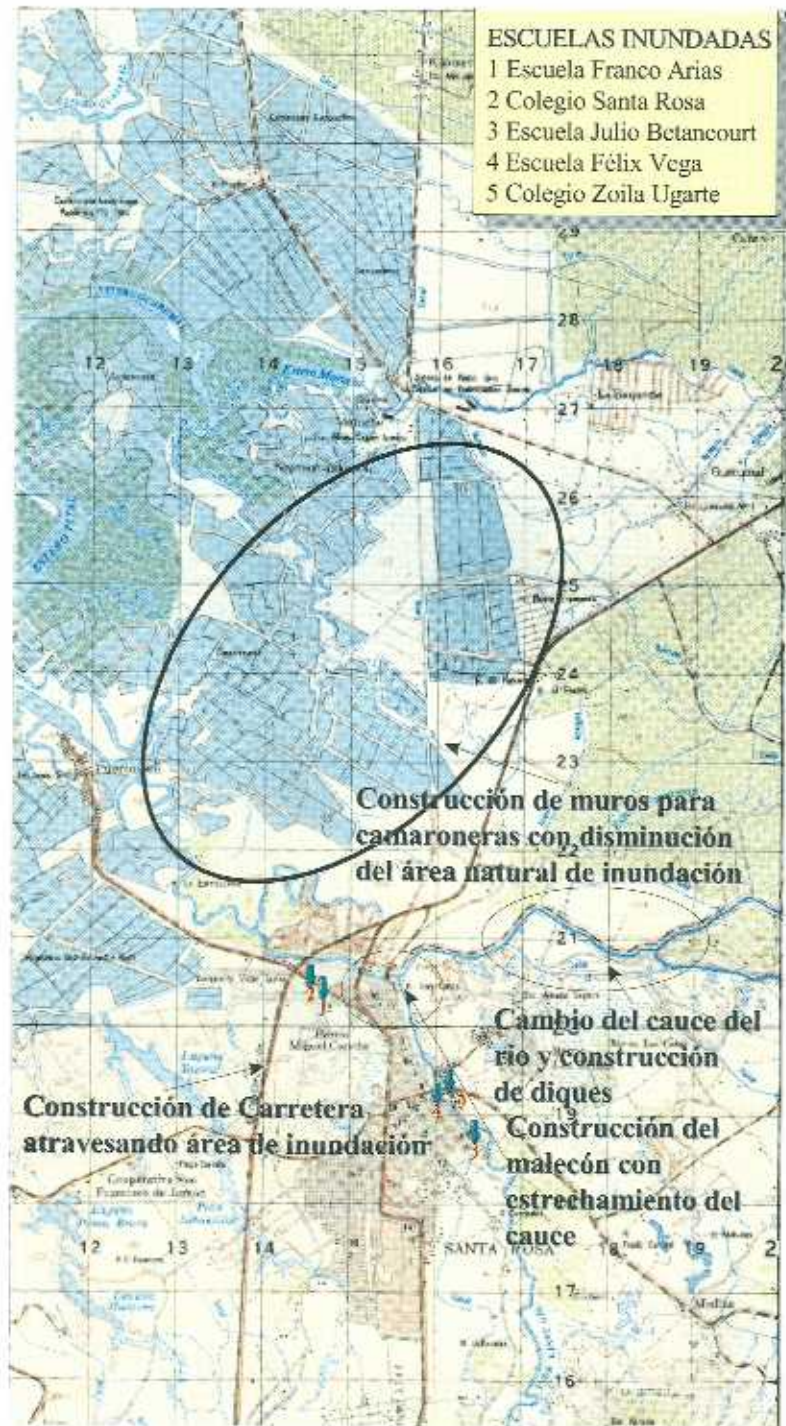
Mapa No. 2. Obras de infraestructura construidas en Santa Rosa - El Oro, sin evaluación de los peligros naturales, lo que ha incrementado la intensidad de las inundaciones durante 1997-1998.
